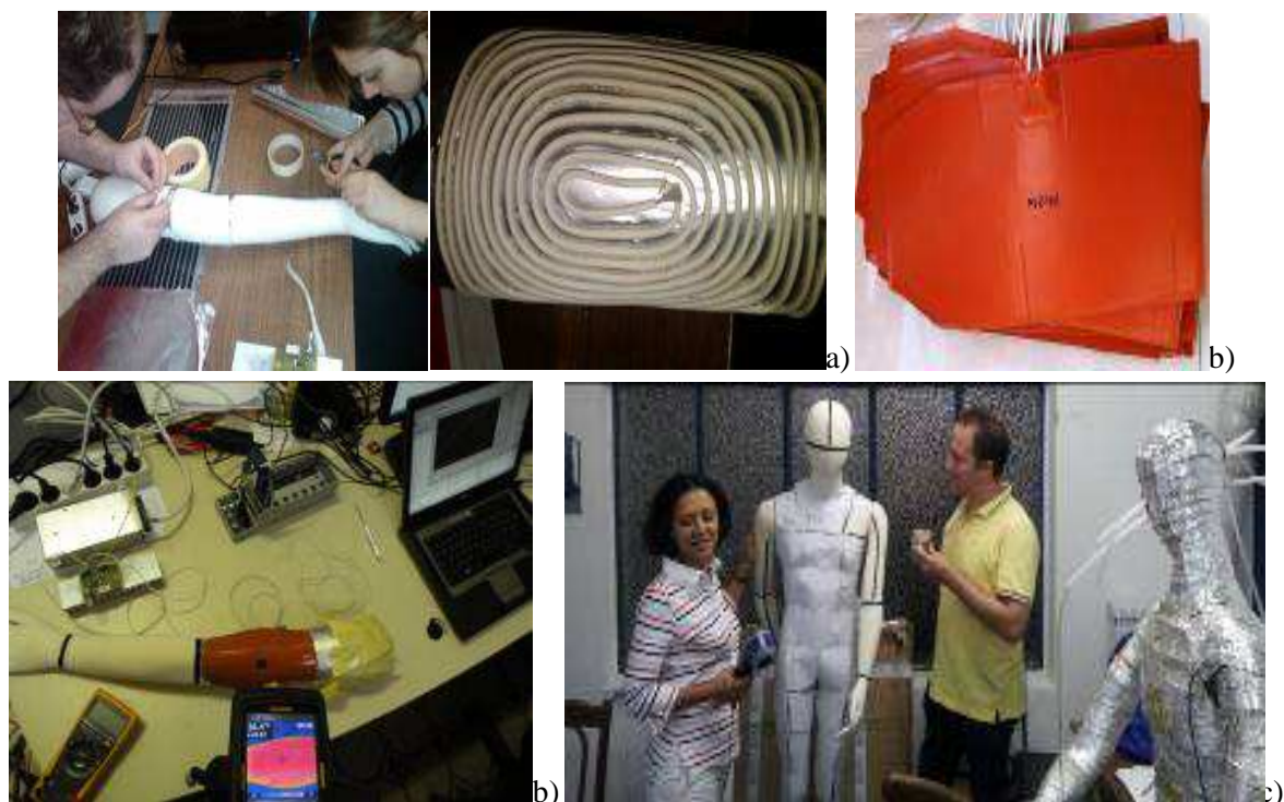
Figura 8: a) Film și fir de nichelină testate, b) Noul material ales și reținut pentru dezvoltarea manechinului, c) împărțirea manechinului în 35 de zone și 90 de subzone - prof. A. Meslem de la Universitatea din La Rochelle în vizită la CAMBI
