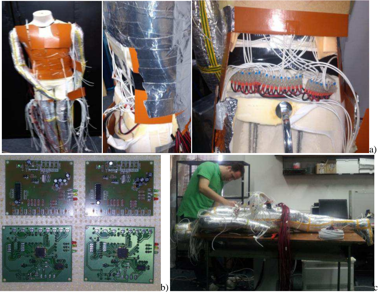
Figura 21: a) Diferite etape de realizare ale noului prototip de manechin termic, b) placuțe de control ale zonelor, c) testarea fiecărei zone în parte
